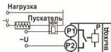
Подключение нагрузки мощностью более 1,5 кВт с помощью электромагнитного пускателя
